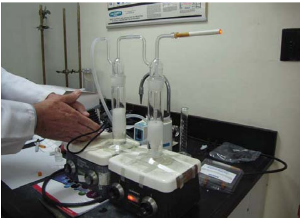
Gambar 9. Sparging apparatus untuk menguji kadar nikotin dan kandungan gas lainnya dari rokok tembakau dan e-cigarette Dikutip dari (29)
